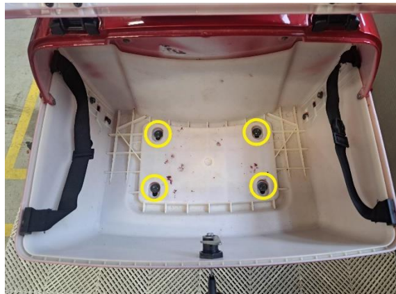
Irrota takaboxin kiinnityspultit (kiintoavain 10 mm, hylsy 8 mm).
